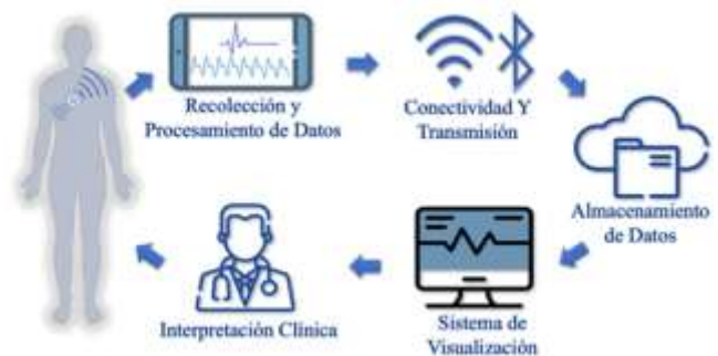
Fig. 1 Esquema visual entre la comunicación de dispositivos entre sí para el registro y monitoreo de señales cardiorrespiratorias.
