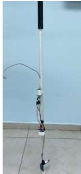
Figura 1. Prototipo del bastón electrónico.
