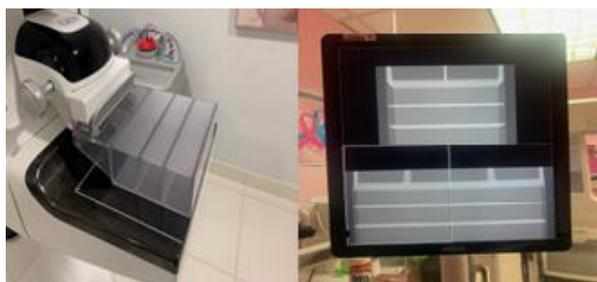
Figura 4. Prueba de Geometría al Mamógrafo marca Hologic
