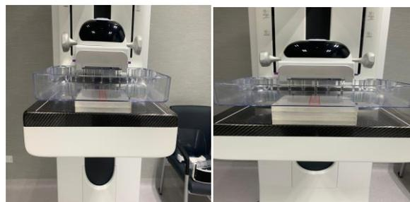
Figura 3. Prueba de CAE. a) 2cm de PMMA comprimido. b) 4cm de PMMA comprimido.
